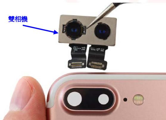
圖 2，iPhone 7 plus 雙相機拆解照片（擷取自 iFixit 網站）
